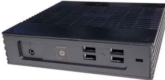
Connectée à un réseau standard **Ethernet TCP/IP** ou **802.11 (réseau sans fil)**, le client léger Axel modèle 90 permet d'accéder aux applications **textes et graphiques** exécutées sur différents serveurs : Windows, Unix/Linux, AS/400, S/390...
